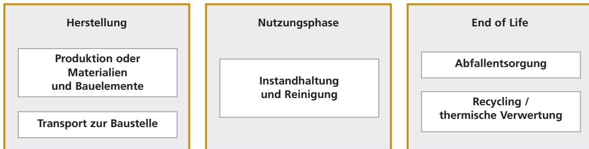
Die ökologische Lebenszyklusanalyse beginnt mit der Berücksichtigung der Rohstoffgewinnung und der Herstellung der eingesetzten Roh- und Hilfsstoffe (Naturstein, Aluminium, Stahl etc.). Die Verarbeitung der Rohstoffe zu Zwischen- und Endprodukten (Natursteinplatten, Fenstern etc.) wird ebenso betrachtet wie der Transport der Bauelemente zur Baustelle.
